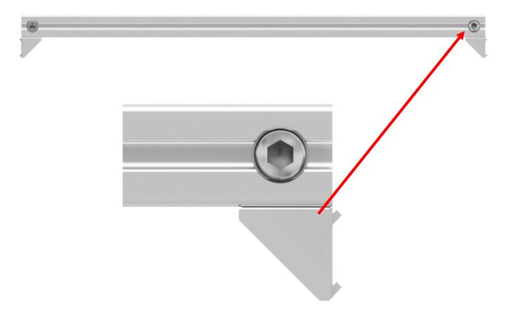
Montieren Sie alle beigefügten Winkel bündig mit diesen Profilen (Schrauben M4x8 und Hammermuttern M4)
