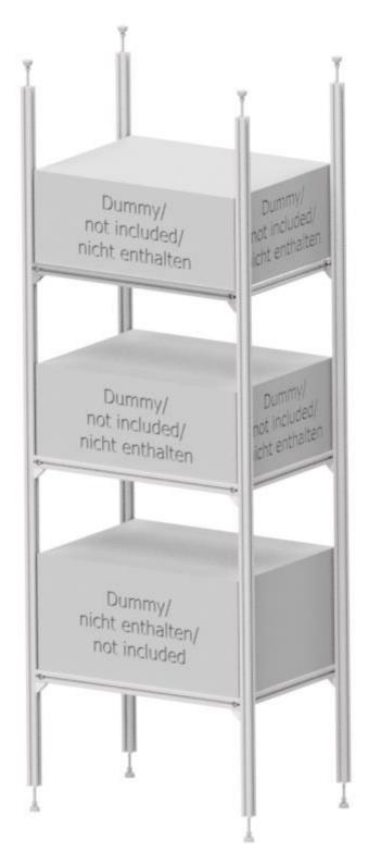
Montieren Sie alle Ebenen an der von Ihnen gewünschten Höhe an den Fußprofilen.
