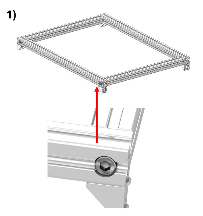
Verbinden Sie alle Eurobox Rahmen mit Hilfe der beigelegten schwarzen Zylinderschrauben (M6) Senkbohrungen sowie Gewinde sind in den Profilen bereits vorhanden
